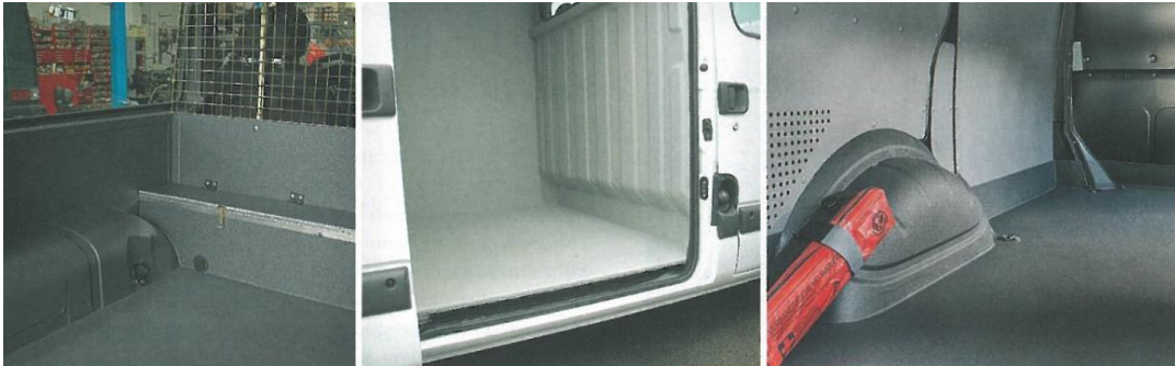
Die Kunststoffversiegelungen (Coatings) der KCN GmbH sind rutschhemmend, nahtlos, wasserdicht, widerstandsfähig, geräuschkämmend, vibrationsdämpfend, wartungsfrei und problemlos zu reinigen. Fahrzeug-Innenräume werden dadurch rutschfest und bleiben lange haltbar. Die Beispiele stammen von der Firma Rockstroh Fahrzeugbau GmbH, die seit einigen Jahren erfolgreich mit der KCN GmbH zusammenarbeitet.
