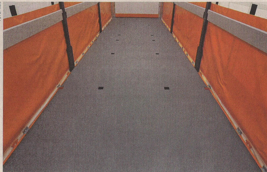
Laderaum eines Sattelauflegers mit KCN-Boden.
